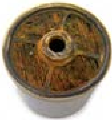
Filtro sin mantenimiento
