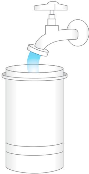
3. Retire el cartucho usado del Sistema de Agua, Pi Water y desenrosque del plato girando en sentido contrario a las manecillas del reloj, como se muestra en la imagen.
